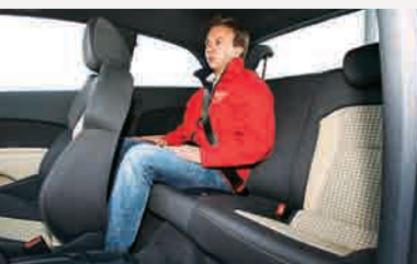
Das abfallende Dach schränkt den Kopfraum spürbar ein
