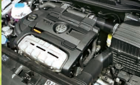
Kompressor und Turbolader sorgen für hohe Leistung und strammen Durchzug
