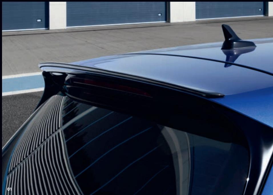
**01** Der differenzierte **Heckspoiler** sorgt speziell für den Golf R mit bis zu 20 kg Downforce für Extra-Abtrieb und verbessert die Straßenlage zusätzlich. **SO**
