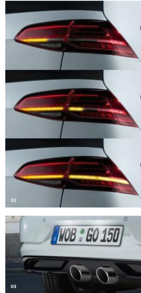
**02** Ein besonderer Blickfang sind die partiell abgedunkelten **LED-Rückleuchten** mit animiertem Blinker. **SO**
