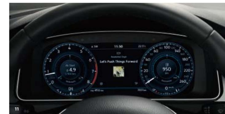
**08-11** Durch verschiedene **Info-Profile** können Sie gezielt Schwerpunkte bei den Daten setzen, die auf dem Active Info Display angezeigt werden. So können auch die in der Mittelkonsole dargestellten Daten des Infotainment-Systems wie Telefonkontakte, Bilder oder CD-Cover im Active Info Display angezeigt werden. Die Info-Profile wählen Sie dabei schnell und unkompliziert über das optionale Multifunktionslenkrad aus. **SO**
