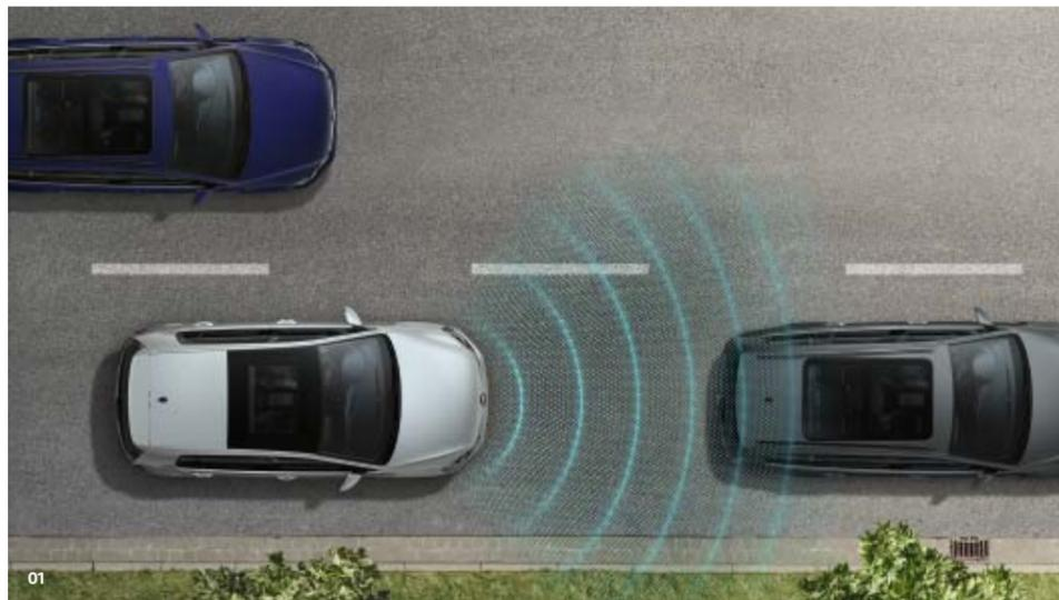
**01** Mehr Komfort, selbst im Stau. Der **Stauassistent** ermöglicht ein komfortables Folgefahren in Stausituationen und kann Ihnen helfen, typische Stauunfälle zu vermeiden.<sup>1)</sup> Das System kann das Fahrzeug in der Spur halten und selbsttätig Gas und Bremse steuern.<sup>1)</sup> **SO**
