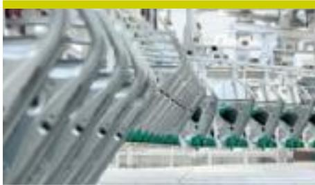
1.800 Roboter in akrobatischer Bewegung fügen 600 Teile zu einer Karosserie. Hohe Automatisierung sorgt für gleichbleibende Qualität. Mit dem Längsträger hinten rechts fängt der Golf an – bei der Taufe. Der „Modulare Querbaukasten“ unterteilt den Unterbau jetzt in drei Teile: Boden vorne, Boden hinten, Boden Mitte. Die drei Baugruppen werden parallel gefertigt und zusammengesetzt. Ähnlich werden noch Seitenteil und Dach verbunden.
