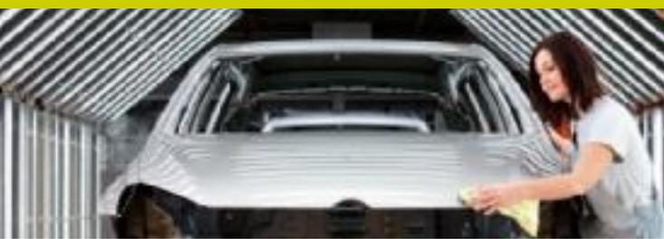
farbige Decklack und obenauf der schützende Klarlack. Volkswagen setzt ausschließlich Lacke auf wasserlöslicher Basis ein. Alle Reinigungs- und Spülmedien sind frei von Lösemitteln; Schwermetalle wurden längst aus dem Prozess entfernt.
