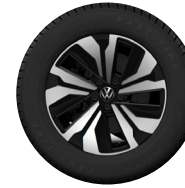
01 Jantes Miami de 18 pouces en alliage usiné (Pneus quatre-saisons 245/60 R18 105T) (Comfortline)
