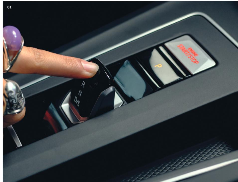
01 Das Doppelkupplungsgetriebe DSG mit dem neu entwickelten kleinen Wahlhebel sorgt für Fahrspaß ohne Unterbrechung. Per Druck auf den Wahlhebel wählen Sie ganz einfach die gewünschte Fahrstufe aus, die dann über das elektrisch verbundene **Shift-by-Wire-Getriebe** umgesetzt wird. **S**
