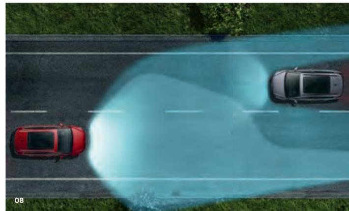
**07** Während der Fahrt kann Sie der **„Blind Spot“-Sensor** über LEDs im jeweiligen Außenspiegel vor Fahrzeugen im toten Winkel warnen.<sup>1)</sup> Beim Rückwärtsausparken kann der integrierte **Ausparkassistent** den Bereich hinter Ihrem Fahrzeug überwachen und Sie so vor erkanntem querendem Verkehr warnen.<sup>1)</sup> **SO**
