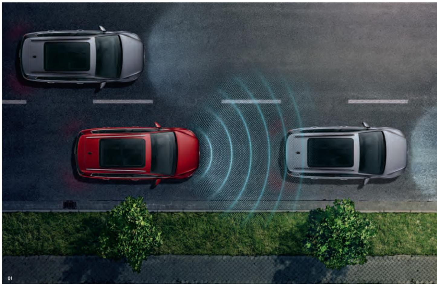
01 Mehr Komfort, selbst im Stau. Der **Stauassistent** ermöglicht ein komfortables Folgefahren in Stausituationen und kann Ihnen helfen, typische Stauunfälle zu vermeiden.<sup>1)</sup> Das System kann das Fahrzeug in der Spur halten und selbsttätig Gas und Bremse steuern.<sup>1)</sup>
