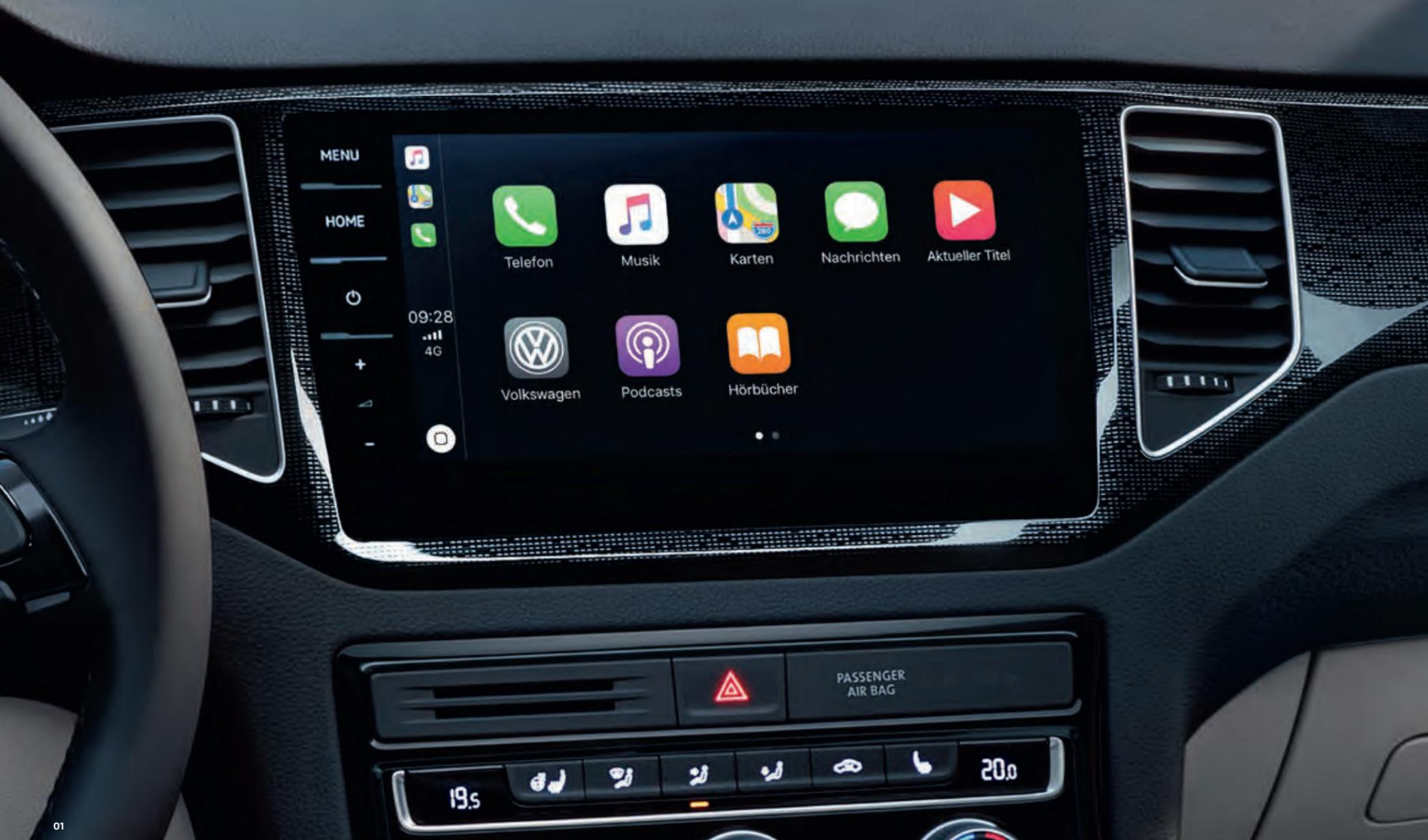
**01** Das **Navigationssystem „Discover Pro“**<sup>1)</sup> mit serienmäßigem App-Connect lässt sich mit seinem 23,4 cm (9,2 Zoll) großen, glasüberbauten TFT-Touchscreen mit Farbdisplay, Annäherungssensoren und innovativer Gestensteuerung intuitiv bedienen. So können Sie eine Reihe von Menüpunkten mit einer einfachen horizontalen Geste ansteuern. Das System mit einem 10 GB großen, frei nutzbaren Speicher verfügt außerdem über
