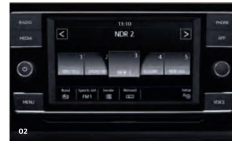
**02** Das Radio „Composition Colour“ mit 16,5 cm (6,5 Zoll) großem TFT-Farbdisplay mit Touchscreen, 4x20 Watt Leistung und bis zu sechs Lautsprechern ist zudem mit zwei USB-Schnittstellen (Typ C) ausgestattet. Zusätzlich können Sie via Bluetooth Ihr Mobiltelefon anschließen. **SO**
