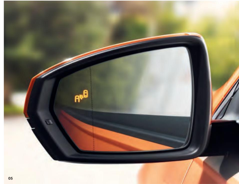
**05** Während der Fahrt kann Sie der **„Blind Spot“-Sensor** über LEDs im jeweiligen Außenspiegel vor Fahrzeugen im toten Winkel warnen.<sup>1)</sup> Beim Rückwärtsausparken kann der integrierte Ausparkassistent den Bereich hinter Ihrem Fahrzeug überwachen und Sie so vor erkanntem querendem Verkehr warnen.<sup>1)</sup> **SO**
