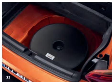
begeistern fahrzeug- und fahrerspezifische Sound-Setups, die auf die jeweilige Ausstattung des Fahrzeugs abgestimmt und im Handel zu programmieren sind. Das System nutzt die im Fahrzeug vorhandenen Lautsprecher und wird in der Reserveradmulde verbaut. Für Fahrzeuge mit einem Reserverad ist das Soundsystem auch für die Verwendung im Gepäckraum erhältlich. Die Fixierung erfolgt in diesem Fall per Klettsystem. **SO**
