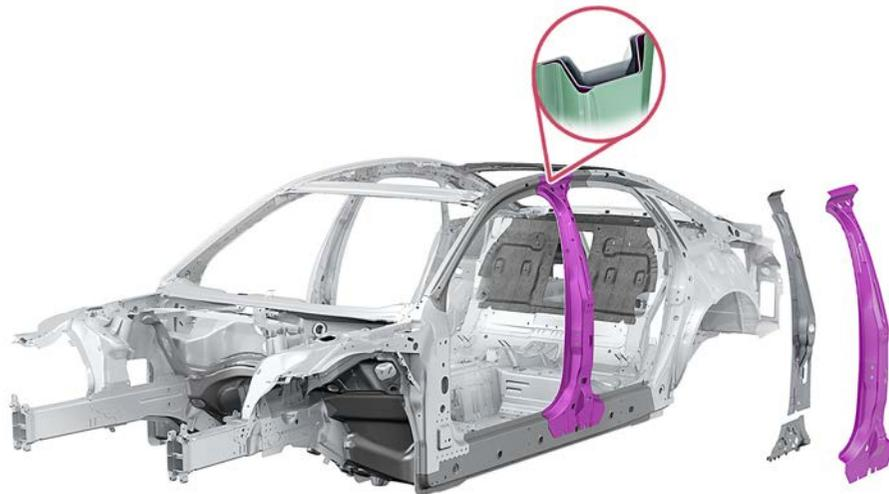
B-Säule mit mehrschaligem Aufbau
