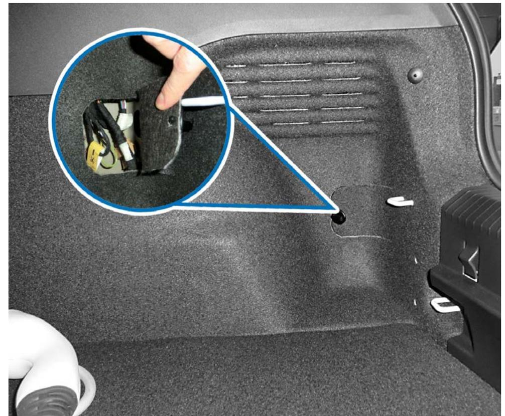
Variante 1: Trennstelle im Gepäckraum (Beispiel ID.3) hinter der Seitenwandverkleidung bis Ende 2020. Das gelbe Fähnchen kennzeichnet die Trennstelle.
