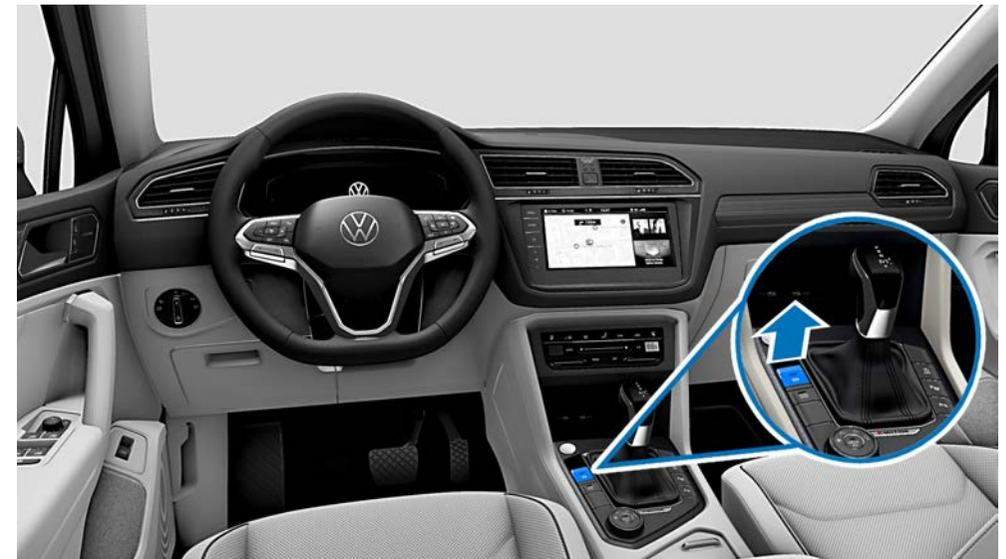
Fahrzeug mit Automatik-Getriebe ohne Wählhebel: „P“-Taste drücken
