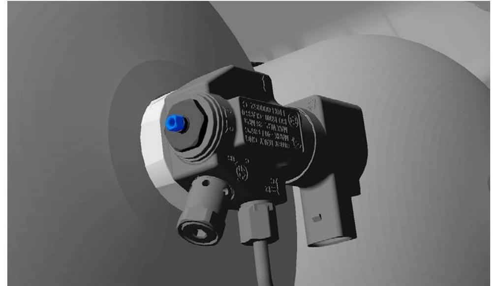
Absperrventil mit 5-er Maulschlüssel bzw. Zange oder Spezialwerkzeug im Uhrzeigersinn bis zum Anschlag drehen.
