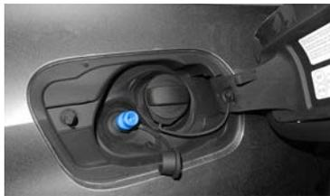
Erdgasanschluss am Tankeinfüllstutzen
