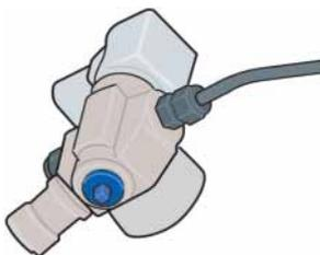
manueller Absperrhahn am Fuß des Flaschenventils.
