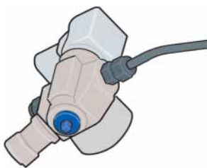
manueller Absperrhahn am Fuß des Flaschenventils.
