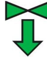
**Sentido de la válvula de seguridad del gas (p. ej., GLP) en el vehículo**
