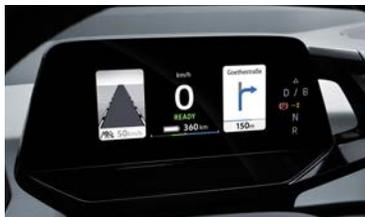
Cuadro de instrumentos digital con indicador de potencia (powermeter) e indicador "OFF" o "READY", mostrado aquí como ejemplo en la familia ID.
