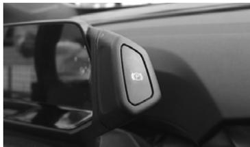
Sin palanca de cambios convencional en la consola central y freno de estacionamiento en el conmutador combinado de la columna de dirección (ejemplo familia ID.).
