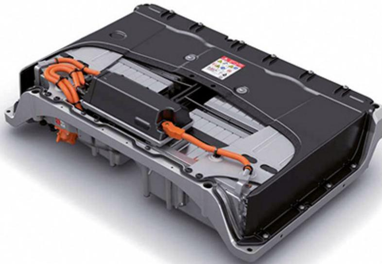
La batería de alto voltaje del Passat GTE
