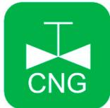
**Válvula manual de cierre del gas con indicación del tipo de gas (GNC)**
