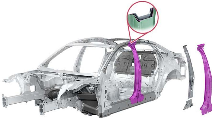
Pilar B con estructura de varias chapas
