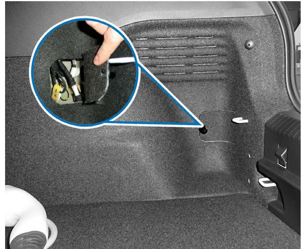
Variante 1: punto de corte en el maletero (ejemplo ID.3) detrás del guarnecido del panel lateral hasta finales de 2020. La banderita amarilla señala el punto de corte.
