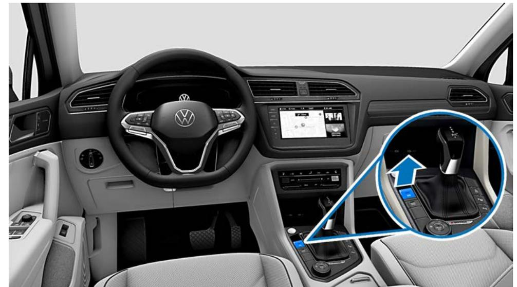
Vehículo con cambio automático sin palanca selectora: pulsar la tecla "P"
