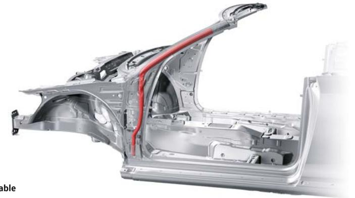
Refuerzo del pilar A en un descapotable
