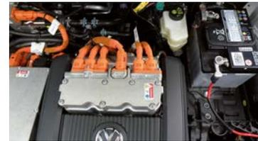
Cables de alto voltaje de color naranja en el vano motor
