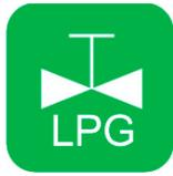
**Válvula manual de cierre del gas con indicación del tipo de gas (LPG)**
