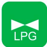
**Valve automatique de sécurité pour gaz avec indication du type de gaz (GPL)**
