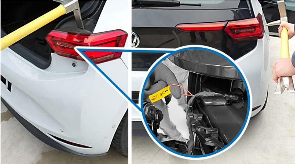
Variante 2 : point de couplage à l'arrière du véhicule, derrière le bloc de feux arrière droit dès le début 2021.
