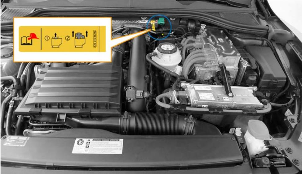
Point de couplage dans le compartiment-moteur des véhicules hybrides (Golf GTE à partir de 2020)
