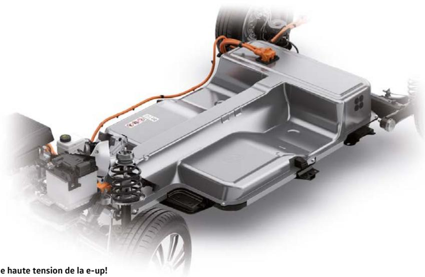
La batterie haute tension de la e-up!
