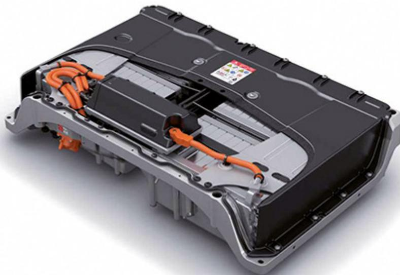
La batterie haute tension de la Passat GTE
