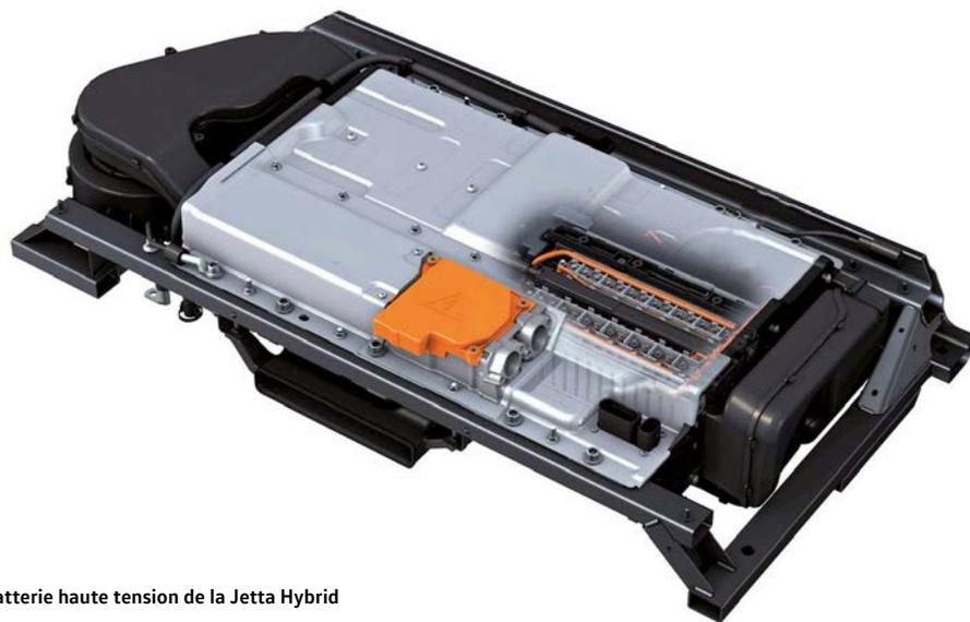
La batterie haute tension de la Jetta Hybrid
