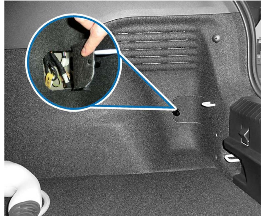
Variante 1 : point de couplage dans le coffre à bagages (exemple ID.3) derrière le revêtement de panneau latéral jusqu'à fin 2020. La petite étiquette jaune permet de repérer le point de couplage.
