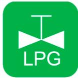
**Vanne manuelle de coupure de gaz avec indication du type de gaz (GPL)**
