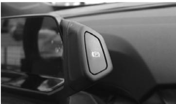
Aucun levier de vitesses conventionnel dans la console centrale et frein de stationnement électromécanique sur le commodo (exemple famille ID.).
