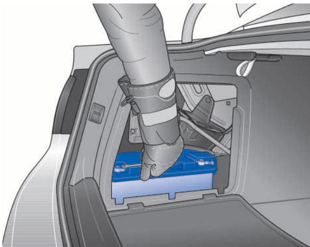
**Abb.: Abklemmen des Masseanschlusses**
