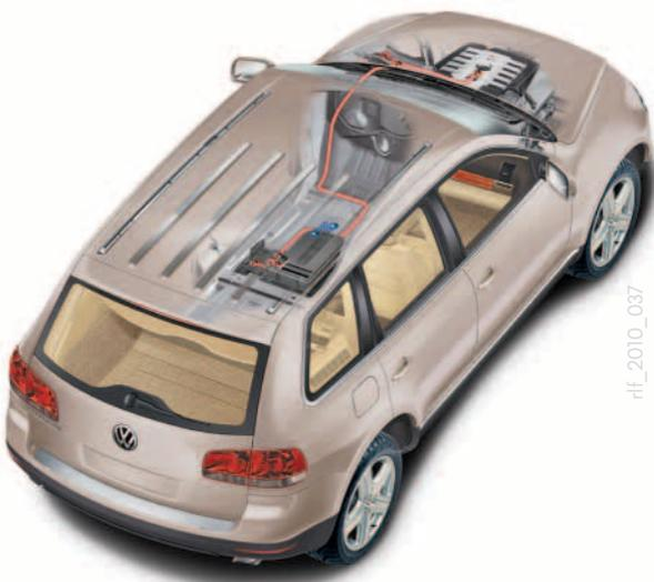
**Abb.: Beispiel für ein Fahrzeug mit Zwei-Batterie-Konzept (Batterien im Motor- und Kofferraum)**
