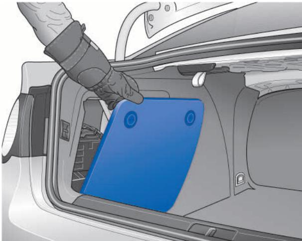
**Abb.: Seitliche Batterieabdeckung im Kofferraum**
