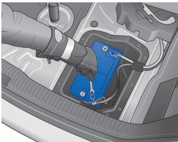
Abb.: Abklemmen des Batteriekabels am Minus-Pol rlf\_2010\_049
