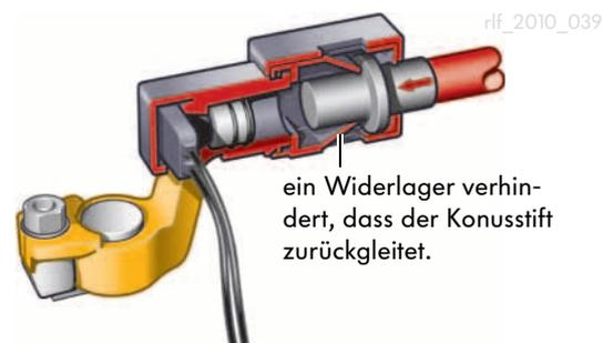
**!** Ein Batterietrennelement trennt nur die Batterie-Plus-Leitung zum Starter (bzw. zur Starterbatterie, wenn mehr als eine Batterie vorhanden ist). Weitere Fahrzeugfunktionen wie Warnblinklicht, Innenraumbeleuchtung und Sicherheitssysteme bleiben weiterhin funktionsfähig. Das bedeutet, die Batterie muss trotzdem abgeklemmt werden!
