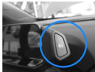
1. Elektrische Feststellbremse lokalisieren.
