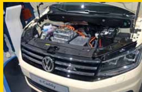
Der ABT e-Caddy hat einen Elektromotor mit 82 kW, der über eine Automatik die Vorderräder antreibt.
