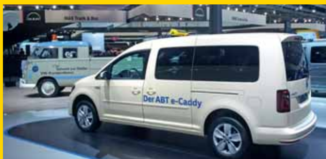
Der ABT e-Caddy basiert wegen des erforderlichen Platzes für die unter dem Laderaum angeordneten Batterien auf dem Caddy Maxi.
